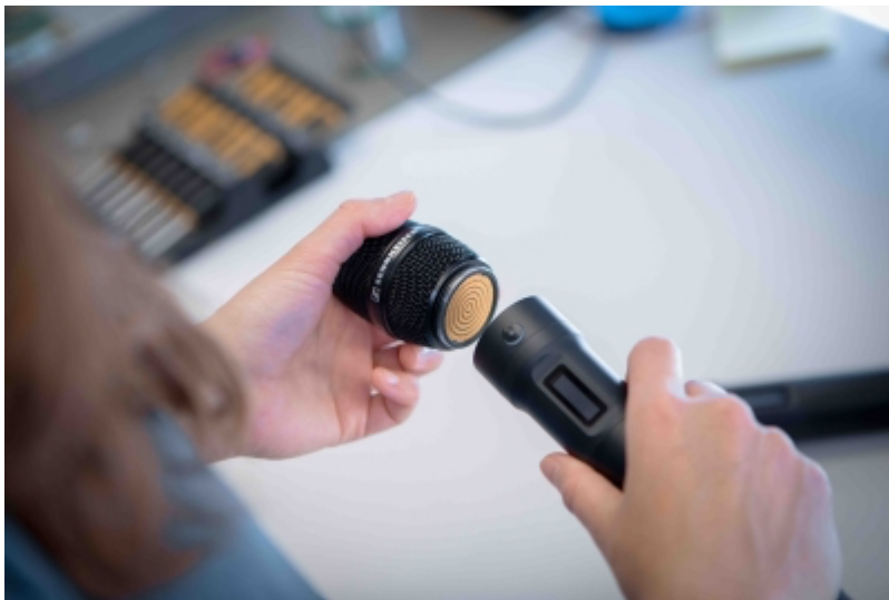
De Command-adapter voor de Spectera SKM voegt bijvoorbeeld een talkback-kanaal toe voor de reporter ter plaatse
